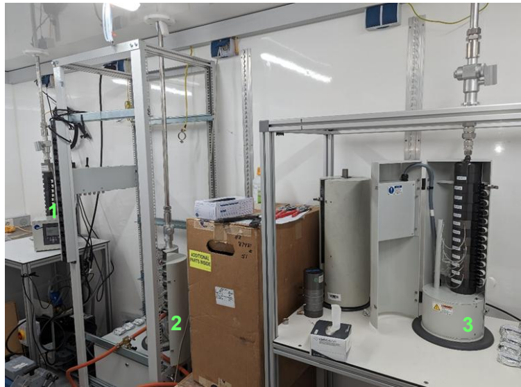
Abb. 8.1: Vergleichsmessungen der drei verschiedenen NanoMOUDI-Sammler im Rahmen einer Kampagne am Standort Riedberg (25.01. – 08.02.2024). Das Foto zeigt den Aufbau innerhalb des Messcontainers, wobei für jeden Impaktor ein eigener identischer Einlass verwendet wurde. Foto: ©IAU-GUF
