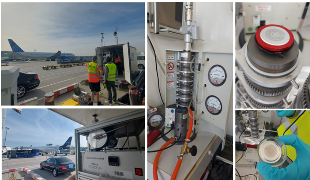
Abb. 5.7: Oben links: TROPOS-Messanhänger im A-Hof, Terminal 1 des Flughafens Frankfurt. Unten links: Thermodenuder/Dual-CPC zur Bestimmung der flüchtigen/nicht-flüchtigen Partikelanzahlkonzentration und Blick auf Position V143. Mittig: NanoMOUDI Kaskadenimpaktor im TROPOS-Anhänger für größen aufgelöste Partikelprobenahme für die chemische Charakterisierung. Oben rechts: NanoMOUDI-Probe von Partikeln > 100 \text{ nm} . Die dunklen Ringe sind die abgeschiedenen Partikel, da sich die Impaktorscheiben während der Probenahme drehen. Unten rechts: NanoMOUDI-Probe der UFP-Stufe 56-100 nm.
