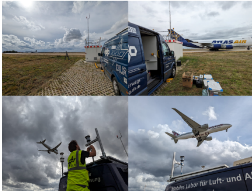
Abb. 5.9: Aufbau am Standort Frankfurt-Flughafen-Ost auf dem Flughafen. Oben rechts ist die Vorbeifahrt eines Flugzeugs erkennbar (meist nicht geschleppt). Die Landungen auf der Südbahn sind mit einem Überflug des Messstandorts verbunden. Fotos: © DLR-VT
